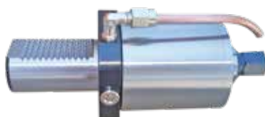
passaggio refrigerante esterno
